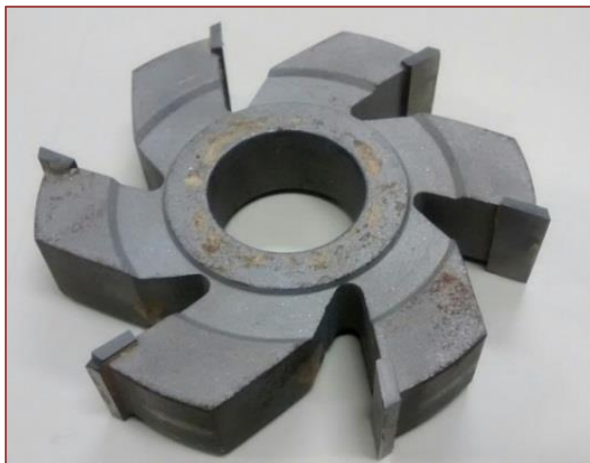
Figura 1 - Fresa utilizada para usinagem de madeira
